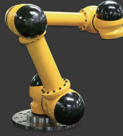
MR ACTUATOR 5개를 이용한 5자유도 다관절 로봇
