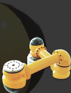
MR ACTUATOR 3개를 이용한 loader, unloader 용 3축 로봇
