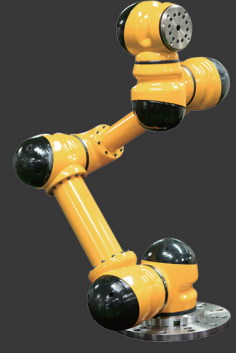
MR ACTUATOR 6개를 이용한 6자유도 다관절 로봇
